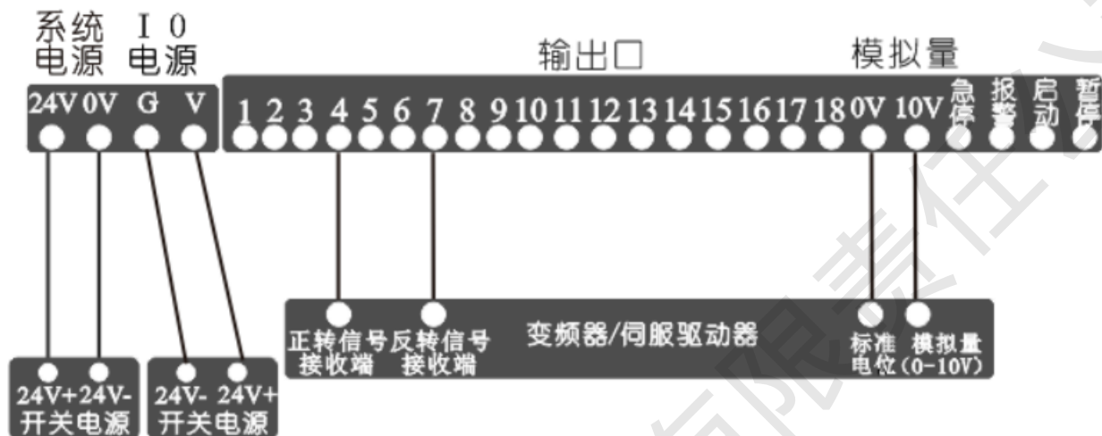
图 5 模拟量输出接线示意图
