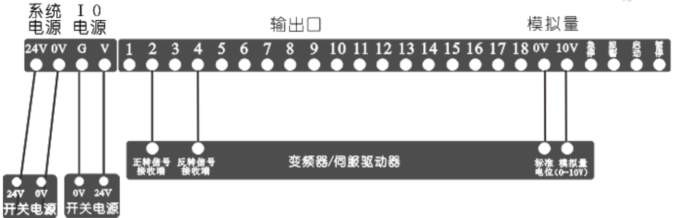
图 6 模拟量输出处接线示意图
